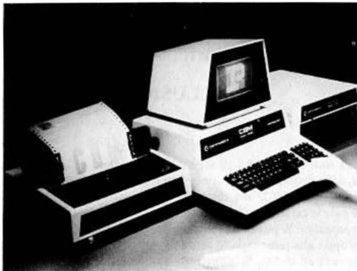
Figura 11.1: Il CBM è un sistema di gestione completo con floppy disk e stampante
