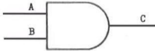
La figura mostra una porta AND con due ingressi A e B con un' uscita C.
