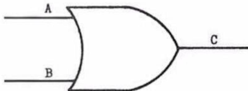
Il suo modo di operare e' che se un "1" e' presente in A o (OR) in B allora l' uscita C e' messa a "1".
